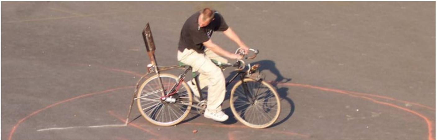
Créé en 2005, il est le premier né de la famille. Un système de pompe gonfle la selle au rythme du pédalier. Les mouvements du guidon permettent de voyager sur une gamme de flûtes alimentées par l'air contenu dans la selle. Ce cyclophone a la particularité de pouvoir se déplacer, une réserve de sable permet de matérialiser la mélodie en une ligne colorée sur le sol. [ici](#), [lien vidéo](#)
