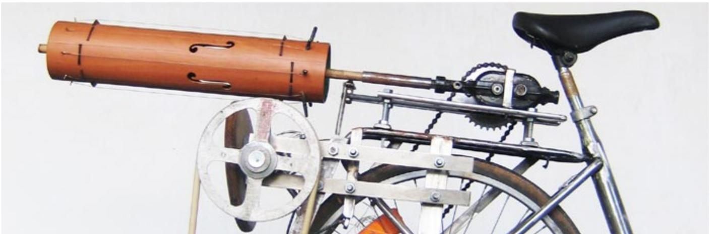
Créé en 2008, ce cyclophone expérimente un type de procédé sonore basé sur le principe de la vièle à roue. Le mouvement du pédalier entraîne la rotation d'une roue de bois qui frotte le bourdon d'un instrument à cordes. Les mouvements du guidon se répercutent dans la rotation de l'instrument permettant au cycliste d'évoluer sur une gamme de sonorités.
