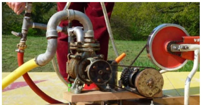
Le fait de pédaler met la pompe en rotation et actionne le circuit d'eau. Des combinaisons de vannes permettent d'orienter l'eau vers différents circuits.
